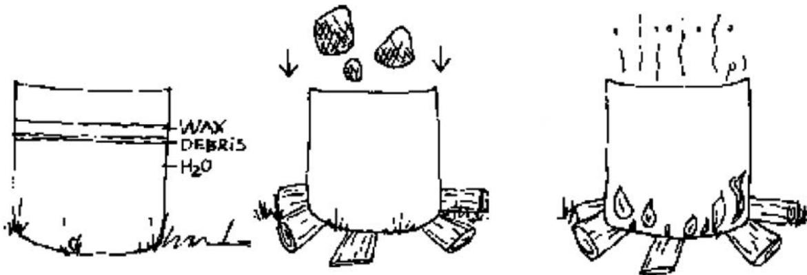
Fig. 60: melting wax
